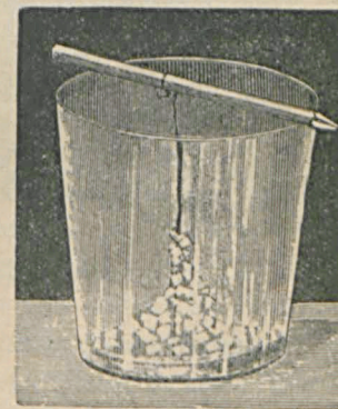
Ryc. 147. Otrzymywanie kryształów soli z roztworu.
