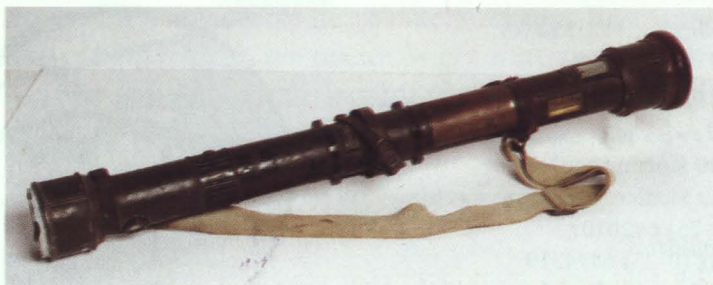
Dalmierz o podstawie 70 cm i powiększeniu 11x, Austria, Wiedeń, C. P. Goerz, przed 1939 r. (MRS/H/180).
