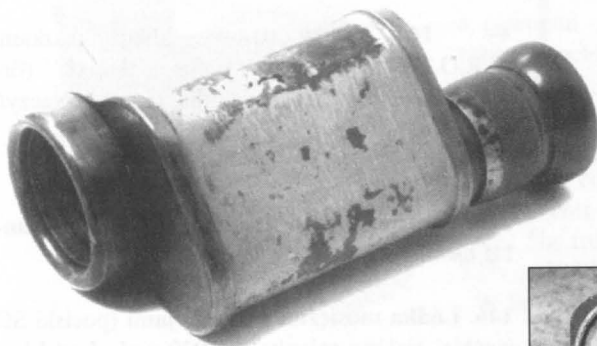
← 150. Lornetka jedno-okularowa, malowana szarą farbą. Obok orła w koronie parametry i numer „6 x 30 / 43825”. Pochodzi z pobojo-wiska pod Hutą Gruszczyño.
