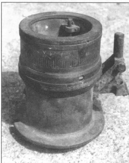
↑ 43. Element celownika artyleryjskiego (Olszyc koło Domanic). Na odlewie aluminiowym „M.S.Wojsk. / 24” i „HUET / PARIS”.
