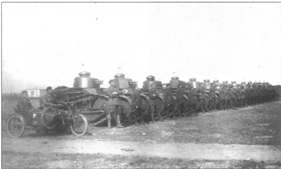
32. 1 Pułk Czołgów. Czołgi lekkie Renault FT-17: drugi i czwarty od lewej z wieżami ośmiobocznymi, pozostałe stożkowymi. Uzbrojenie: 3, 5, 8, 10, 13 i 15 od lewej uzbrojone w karabiny maszynowe Hotchkiss wz 25, pozostałe w działka 37 mm Puteaux. Fot. A. Milewski, Mława.
