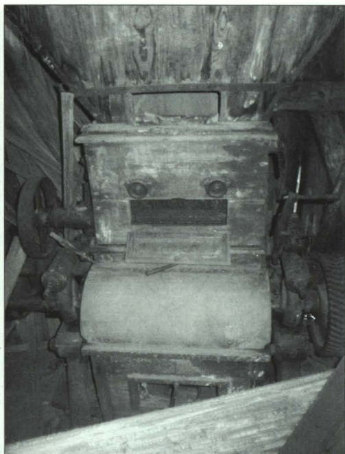
Wnętrze wiatraka – mlewnik walcowy w drewnianej obudowie.
