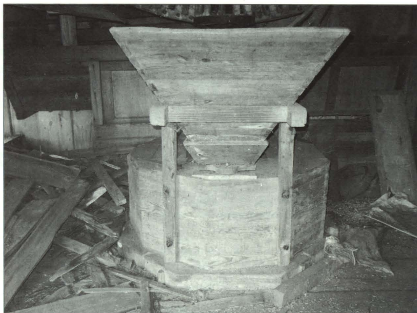
Złożenie kamieni młyńskich w drewnianej obudowie, tzw. łubie z koszem zasypowym.
