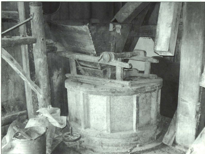
Złożenie kamieni w metalowej obudowie.
