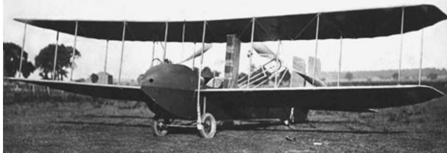
U góry: Flyer I (1903 r.) ze śmigłem skierowanym do tyłu (pchającym) i sterem wysokościowym z przodu. U dołu: Wright Model H (1914 r.) z kołami, opływowym kadłubem i sterem wysokościowym z tyłu, ale z zachowanym układem napędowym w postaci dwóch śmigieł pchających
