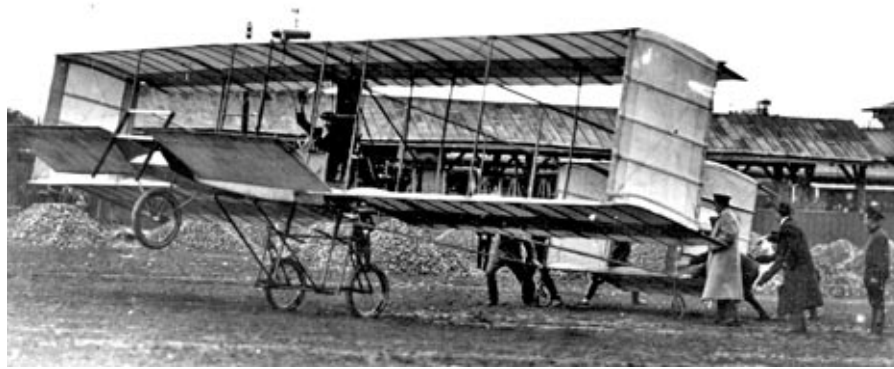
Georges Legagneux za sterami samolotu „Voisin”, którym latał w 1909 r. podczas poka- zów w Warszawie i Moskwie. Maszyny działającej od 1905 r. firmy Soci t é Anonyme des Aéroplanes G. Voisin miały śmigło pchające, ster wysokości z przodu oraz przypominają- cą latawiec skrzynkowy konstrukcję skrzydeł i opierzenia tylnego.
