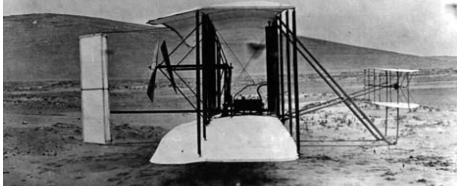
U góry: Flyer I (1903 r.) ze śmigłem skierowanym do tyłu (pchającym) i sterem wysokościowym z przodu. U dołu: Wright Model H (1914 r.) z kołami, opływowym kadłubem i sterem wysokościowym z tyłu, ale z zachowanym układem napędowym w postaci dwóch śmigieł pchających
