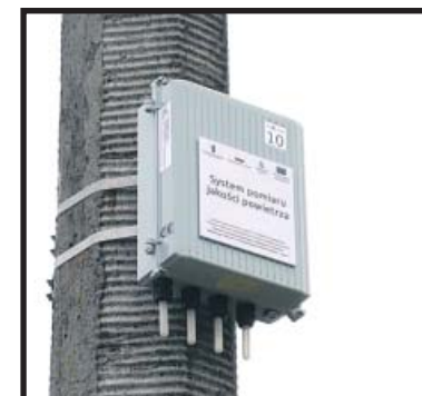
W Białej Podlaskiej zamontowano 10 czujników, mierzących stężenie w powietrzu pyłów PM1, PM2,5 i PM10
