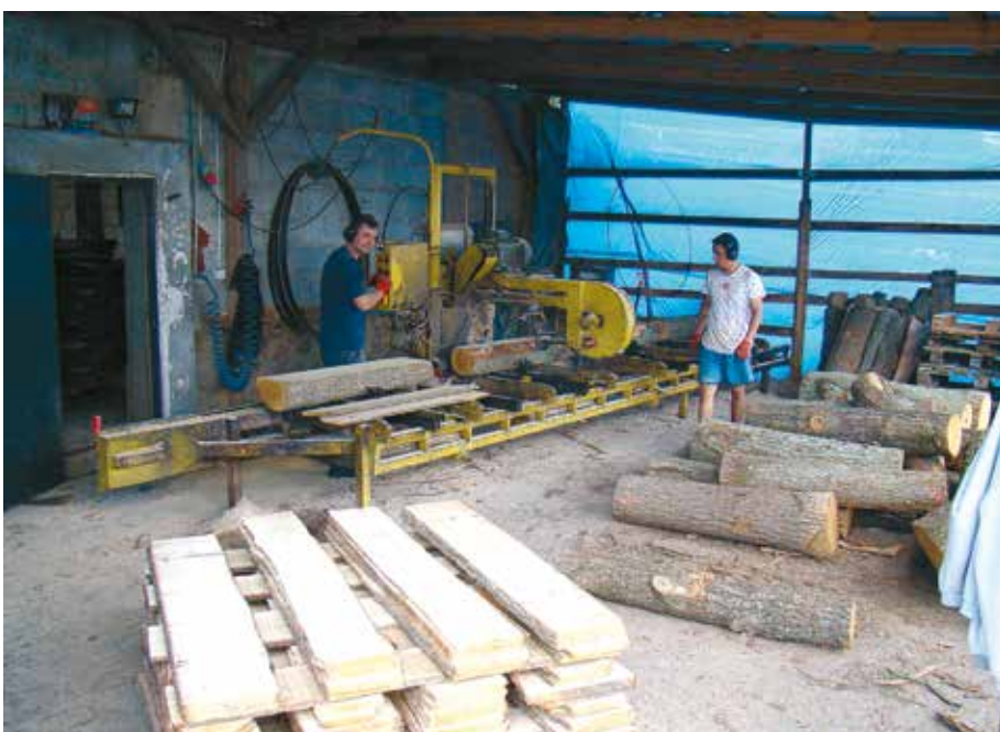
Kłody przeciarane są w deski, następnie z deski – w listwy, a później pracownicy eliminują błędy, czyli wycinają gotowe elementy, odrzucając sęki, jakieś wady, pęknięcia, rdzenie itp.
