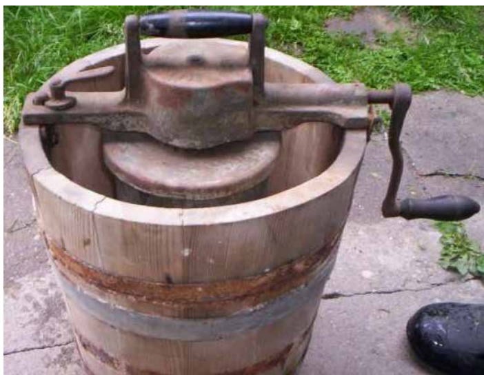
Beczka do ukręcania i chłodzenia lodów ze znajdującą się w środku kanką
