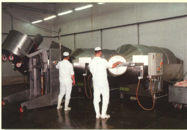
Masownice próżniowe - nowoczesne urządzenia wykorzystywane w procesie peklowania mięsa Modern vacuum equipment used for pickling meat
